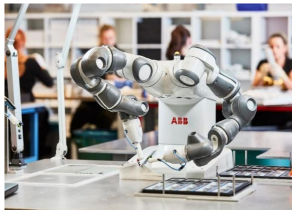
Фиг. 1. Колаборативен робот ABB YuMi®
