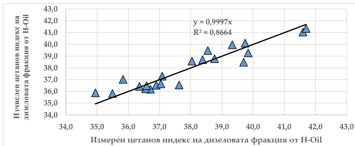
Фиг. 12. Цетанов индекс на Н-Ойл дизел като функция от качеството на суровината и конверсията в Н-Ойл.
