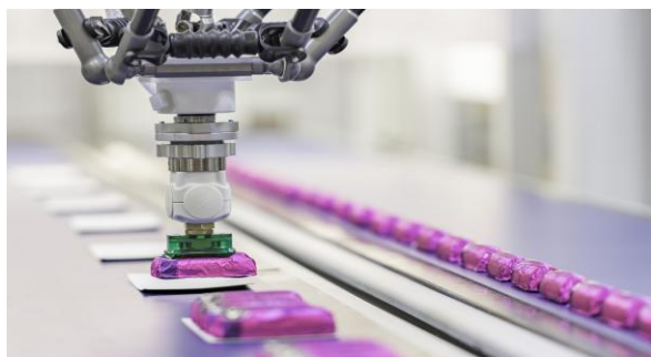
Фиг. 4. Модул за проследяване на конвейер
